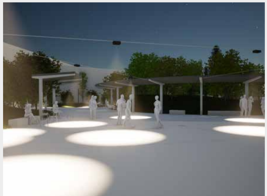
Vista de las luminarias suspendidas en una red de hilos tendidos entre mástiles, que iluminan los recorridos y las zonas de estancia.
